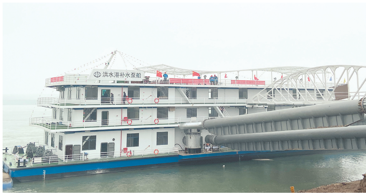
图为补水项目核心工程,国内同类最大的取水泵船。记者 丁瑜 摄
