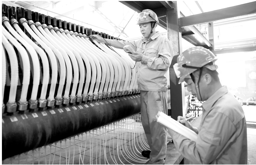
巴陵石化切实加强夏季安全清洁生产,落实防暑降温措施,夯实安全环保基础。目前,该公司60多套炼油、化工及动力等装置保持平稳运行,炼油化工产品日产量1.3万吨左右。图为该公司树脂部年产5万吨离子膜烧碱装置电解单元生产现场,烧碱装置(车间)当班员工在超过40摄氏度的工作环境中巡检,认真测量电槽电压,做好记录。 彭展 摄
